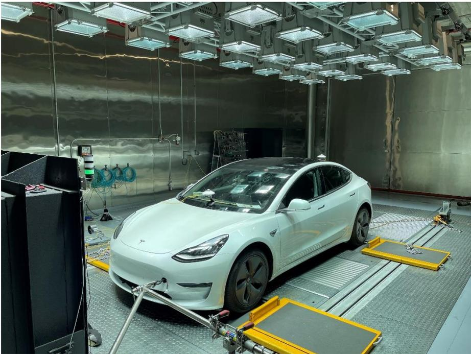
Das neue Solarsimulationssystem spielt eine entscheidende Rolle bei weltweit gültigen regulatorischen Tests sowohl für Elektrofahrzeuge als auch für Fahrzeuge mit Verbrennungsmotor.
