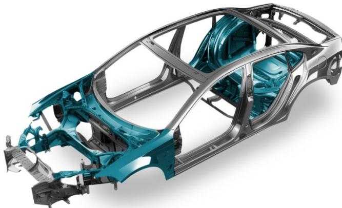
**Bildunterschrift:** FEVs Multi-Material Ansatz kombiniert Blechbauteile mit Versteifungen im Gussverfahren und erlaubt so leichte Karosseriebaugruppen.
